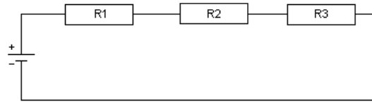
Figura 191: Circuitos de 3 resistencias en serie
