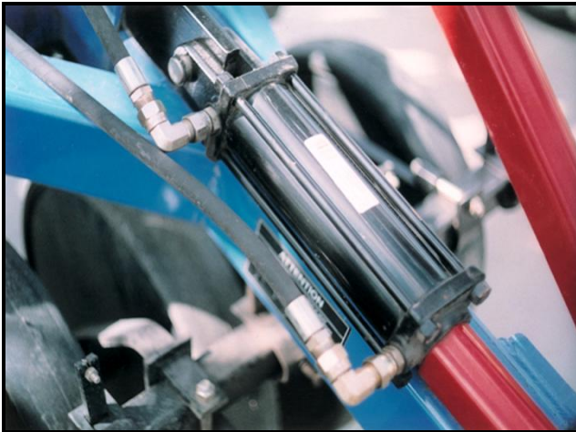
Figura 314: Cilindro con tirantes
