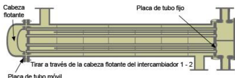
Figura 354: Cabeza flotante, intercambiador
