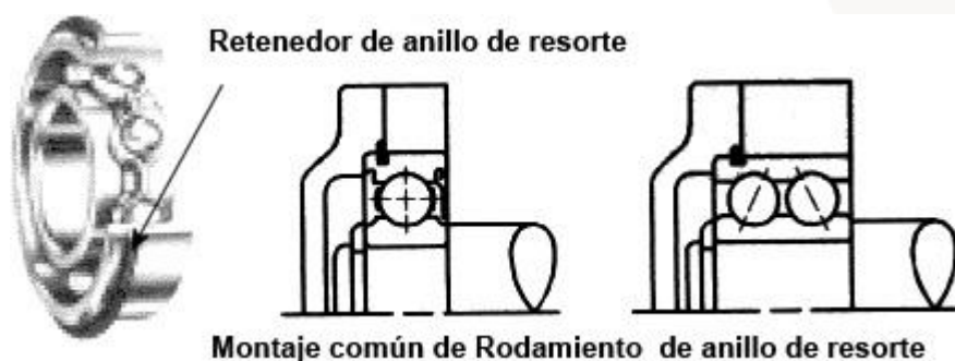
Figura 384: Retenedor del anillo elástico
