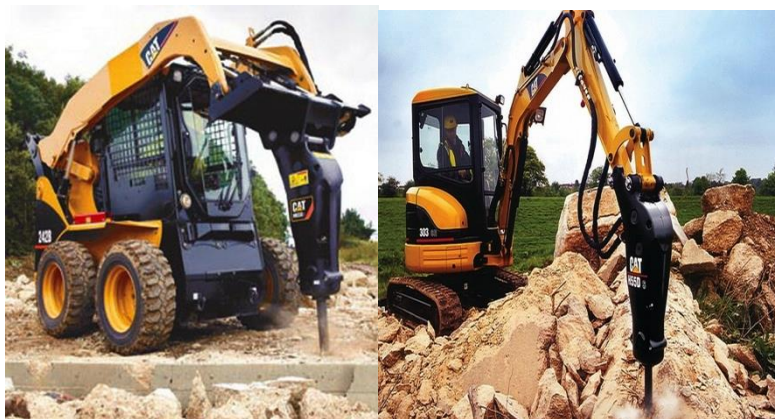
Figuras 32-33 Ejemplos de martillos hidráulicos móviles rompiendo rocas y hormigón
