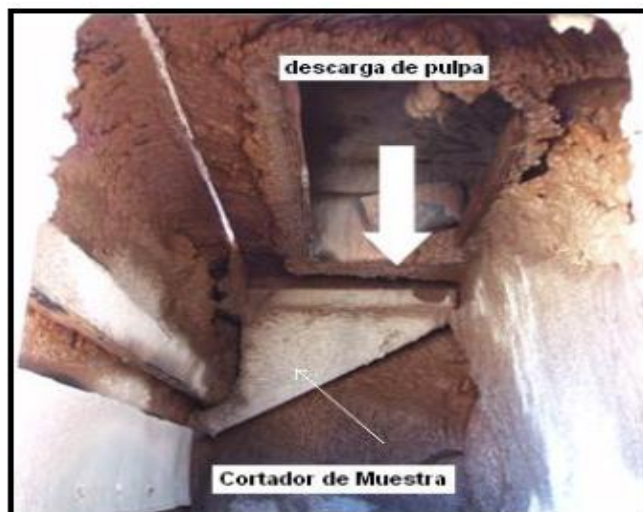
Figura 27 Cortador automático de muestras de pulpa
