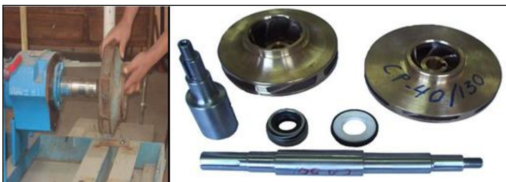
Figura 90 Eje bomba centrífuga
