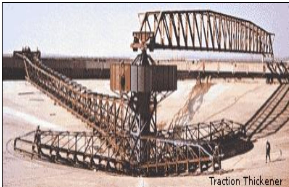
Figura 182 Riel periférico de un espesador de tracción.
