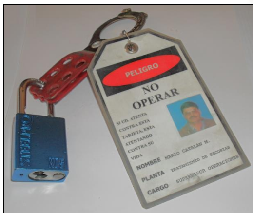
Figura 9 Componentes de un bloqueo
