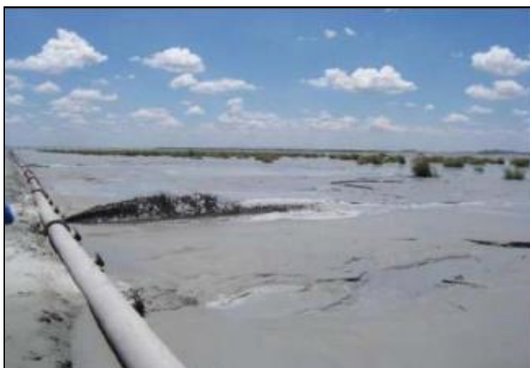
Figura 70 Depositación de la pulpa mediante spigot
