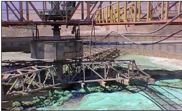
Figura 192 Espesador embancado.
