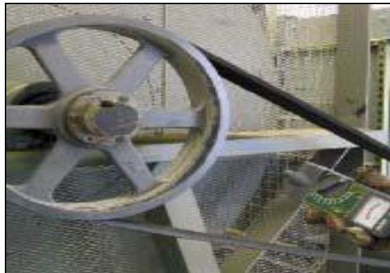
Figura 92 Transmisión por correas
