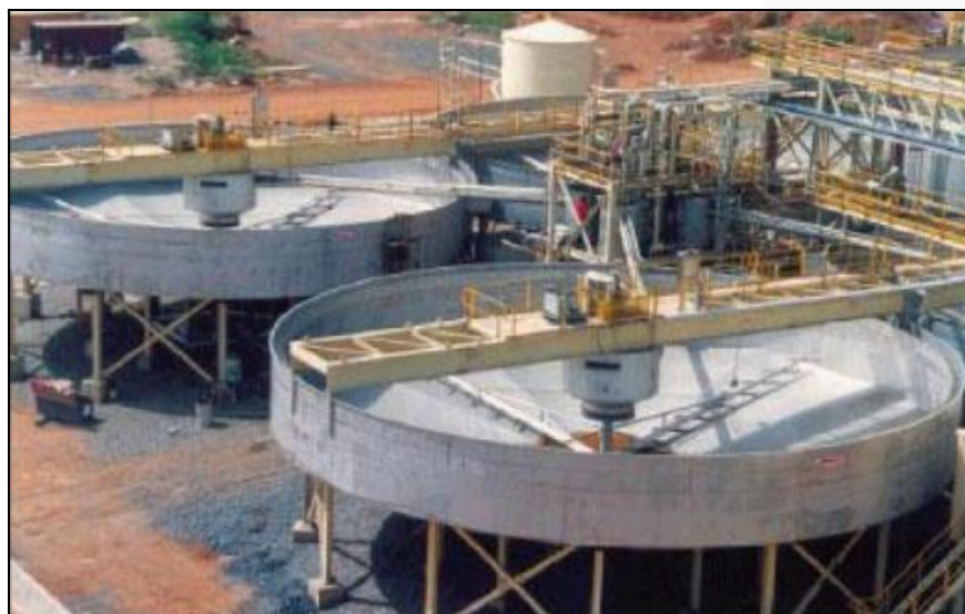
Figura 187 Espesador de alto ratio
