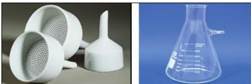
Figura 138 Embudo buchner y matraz de kitasato
