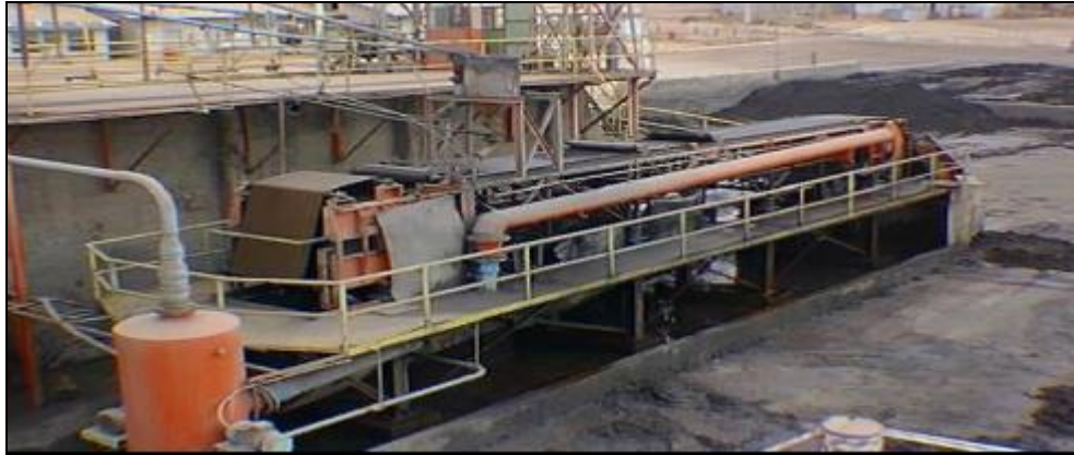
Figura 110 Filtro de banda
