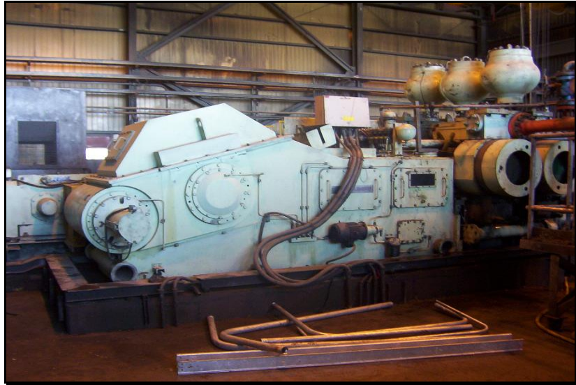
Figura 152 Bombas de desplazamiento positivo
