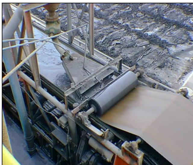
Figura 112 Distribuidor de pulpa de filtración
