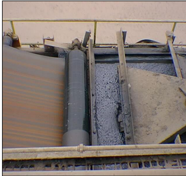
Figura 113 Rodillo de retención
