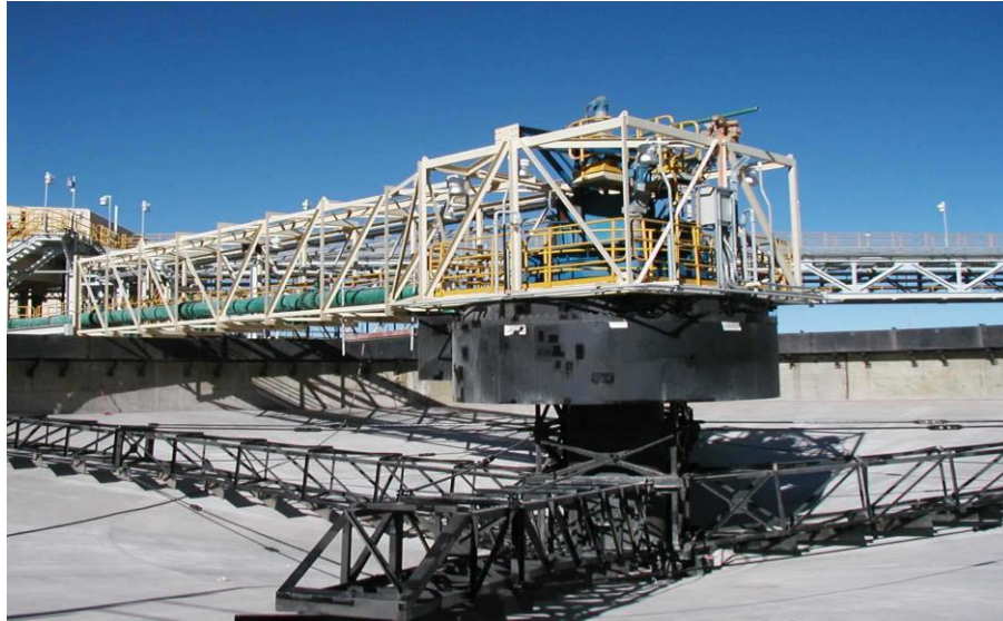
Figura 177 Espesador convencional
