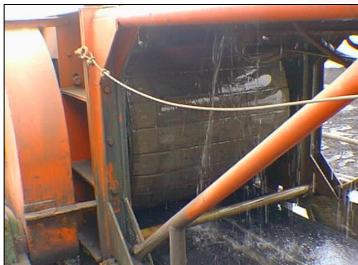
Figura 115 Polea conducida
