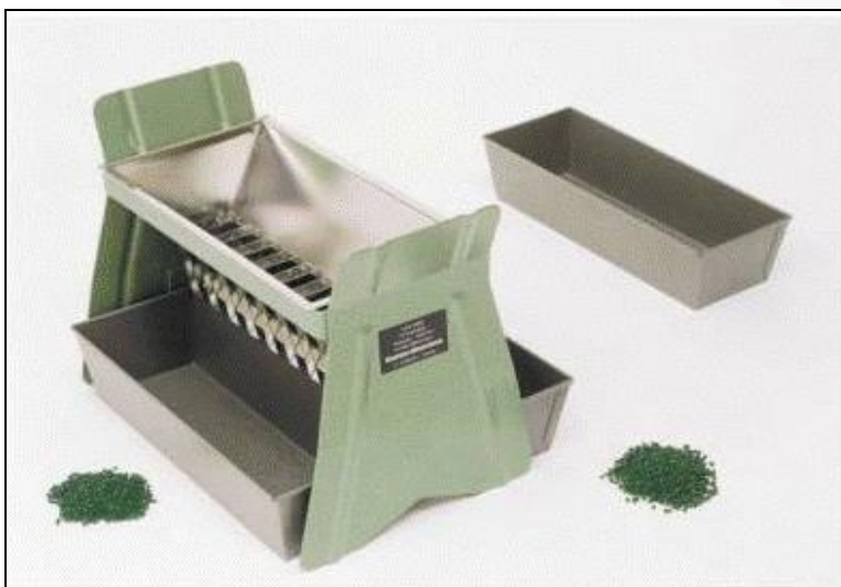
Figura 43 Cortador de muestra Riffle (Tyler)
