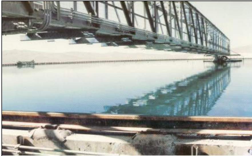
Figura 182 Riel periférico de un espesador de tracción.
