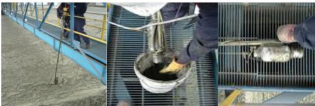
Figura 26 Muestreador de profundidad
