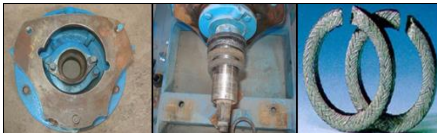
Figura 88 Tipos de empaquetaduras
