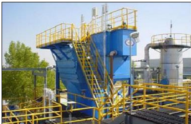
Figura 165. Clarificador de placas inclinadas.
