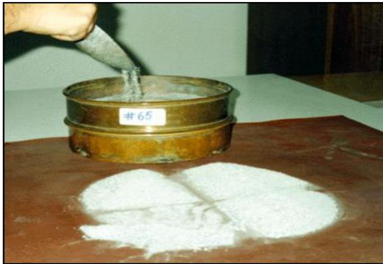
Figura 44 Alimentación de muestras en tamices
