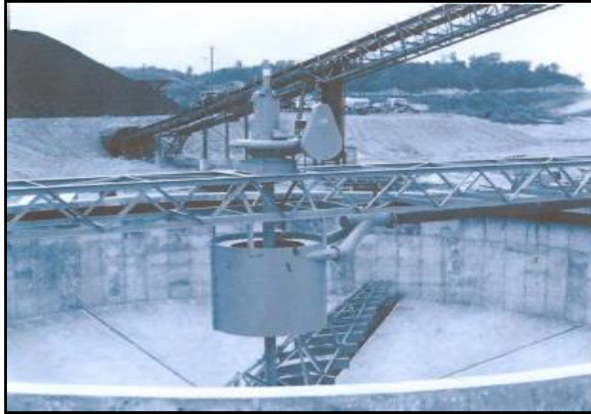
Figura 186 Espesador de alta capacidad
