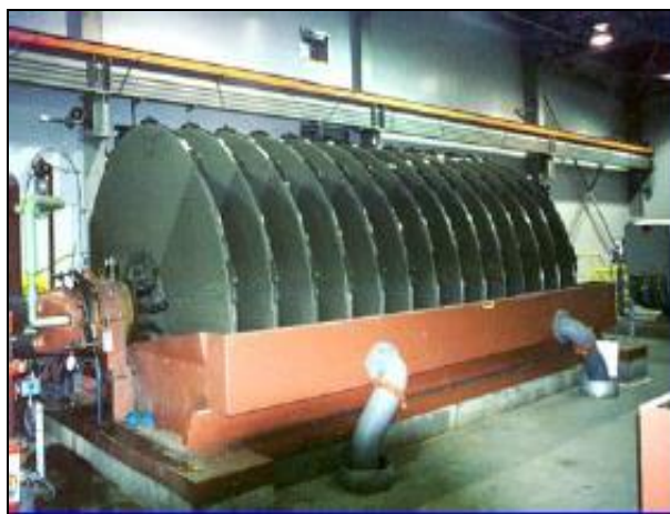
Figura 104 Filtro de discos
