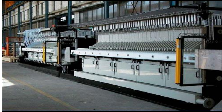
Figura 121 Filtro de prensa vertical
