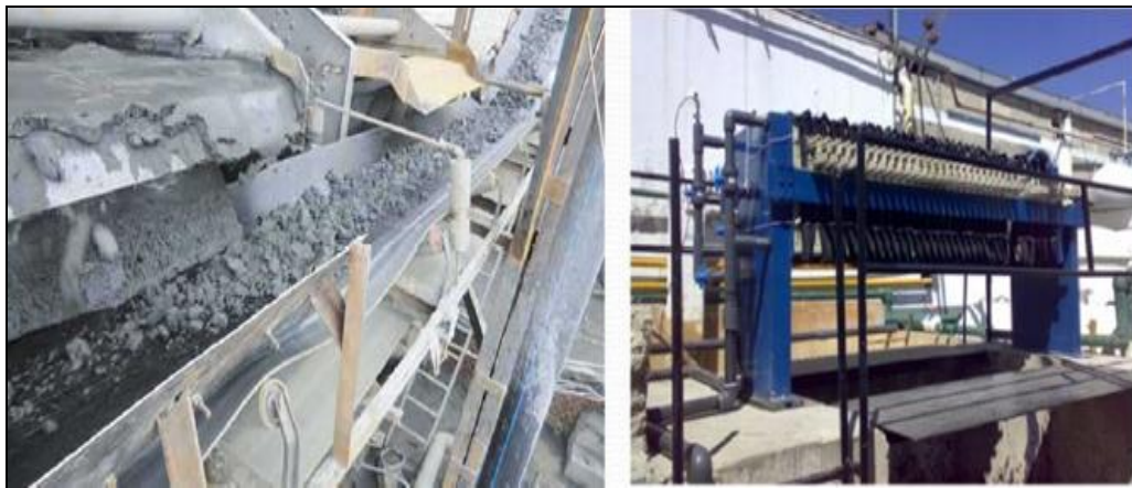
Figura 75 Filtro de banda y filtro de prensa
