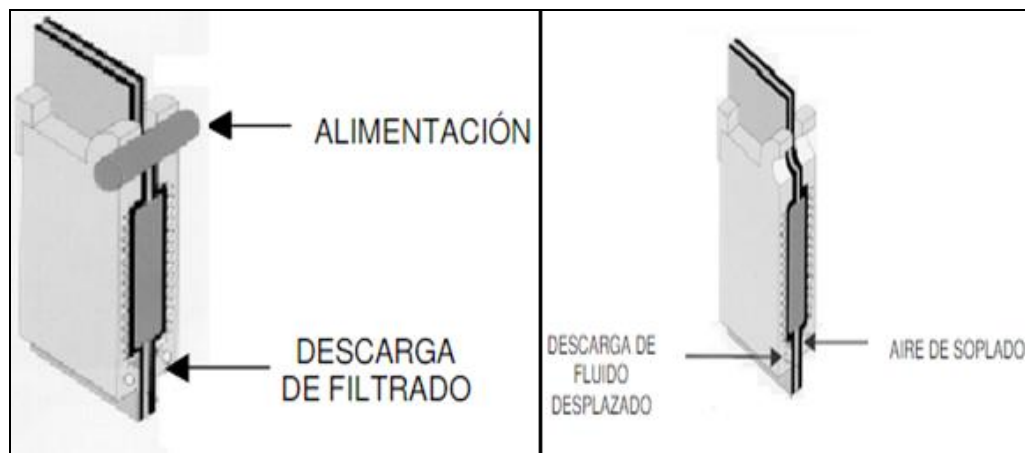
Figura 124 Etapas del filtro vertical
