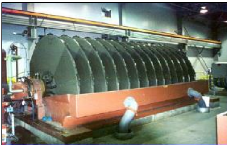
Figura 165 Filtro de discos.
