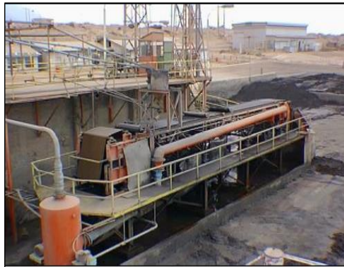
Figura 171 Filtro de banda
