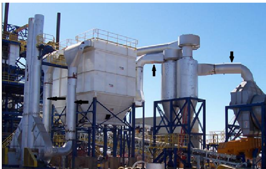
Figura 271 Ductos de una planta de secado
