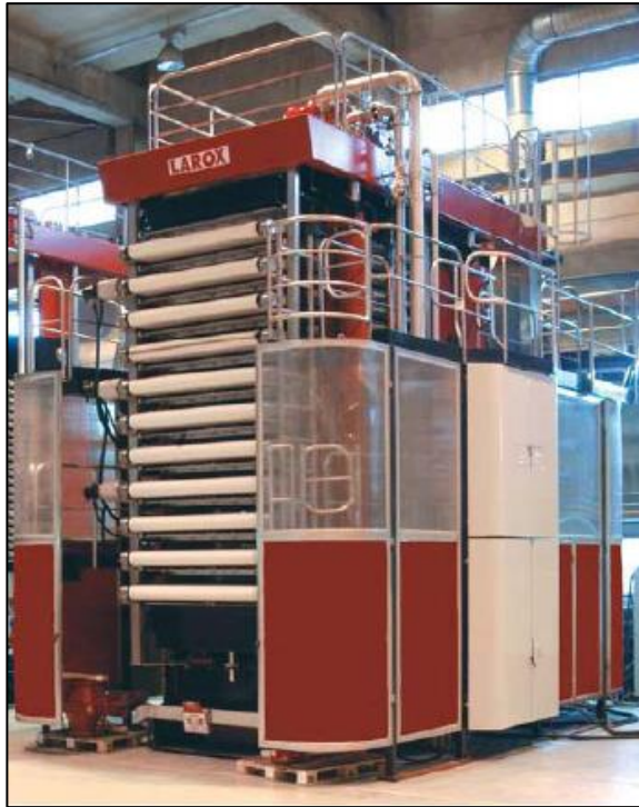
Figura 191 Filtro de prensa de placas horizontales Larox
