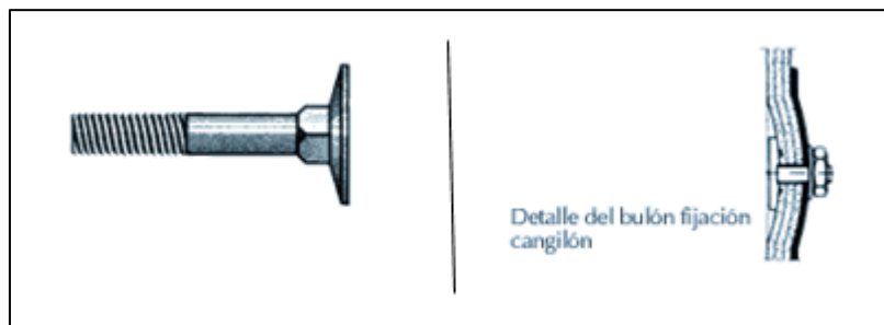
Figura 295 Detalle del perno bulón de fijación del cangilón
