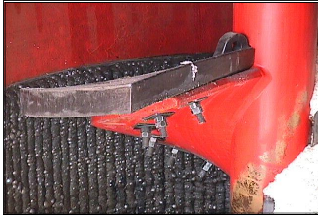
Figura 95 Sistema de sujeción de pernos del tornillo.
