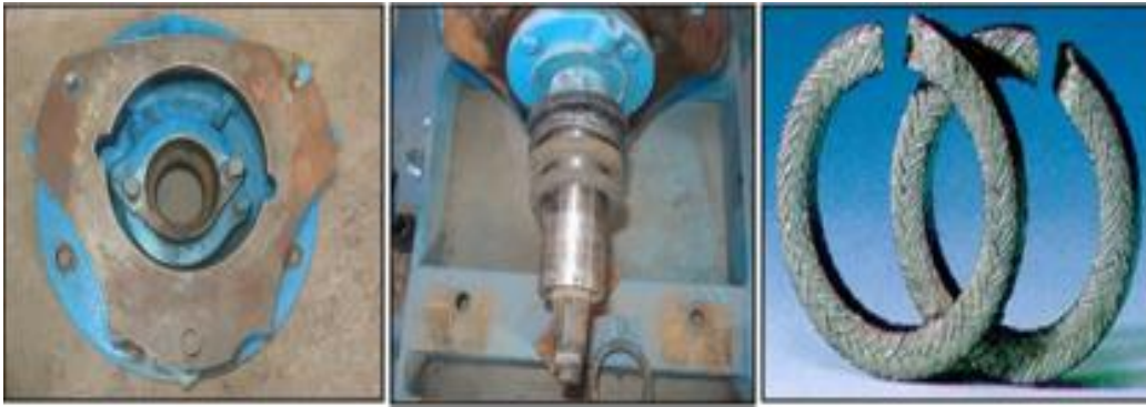
Figura 112 Tipos de empaquetaduras.
