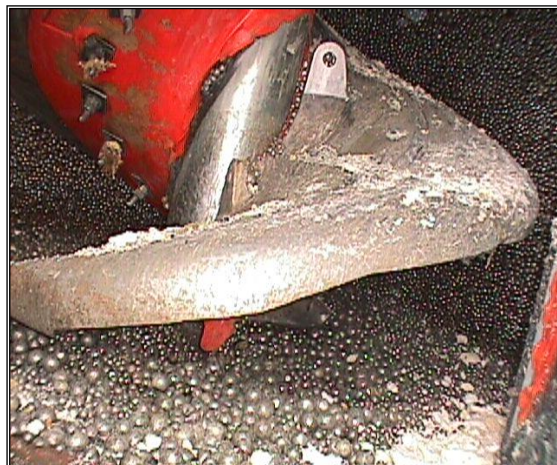
Figura 96 Tornillo helicoidal doble con revestimiento metálico desgastado
