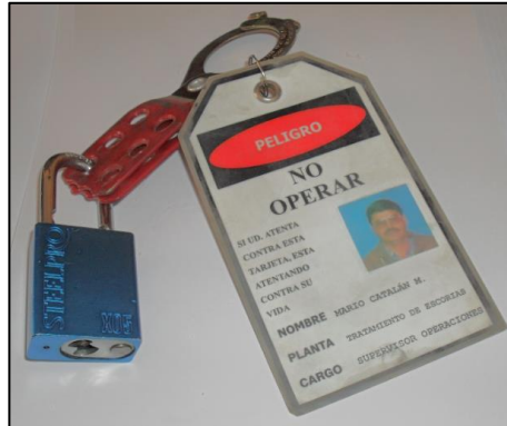
Figura 9 Componentes de un bloqueo
