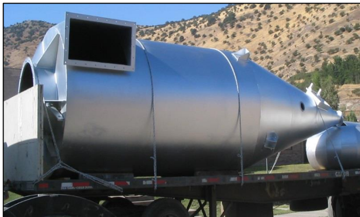
Figura 263 Ciclón recuperador de polvo
