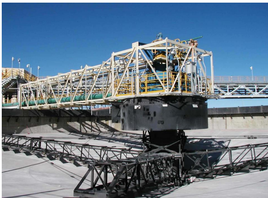
Figura 144 Espesador convencional
