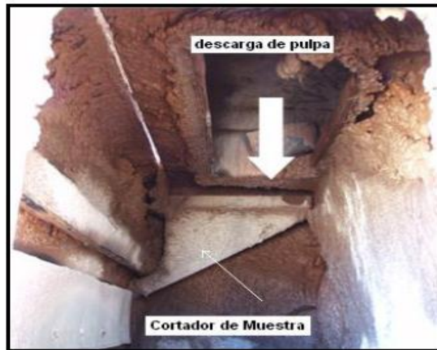
Figura 27 Cortador automático de muestras de pulpa
