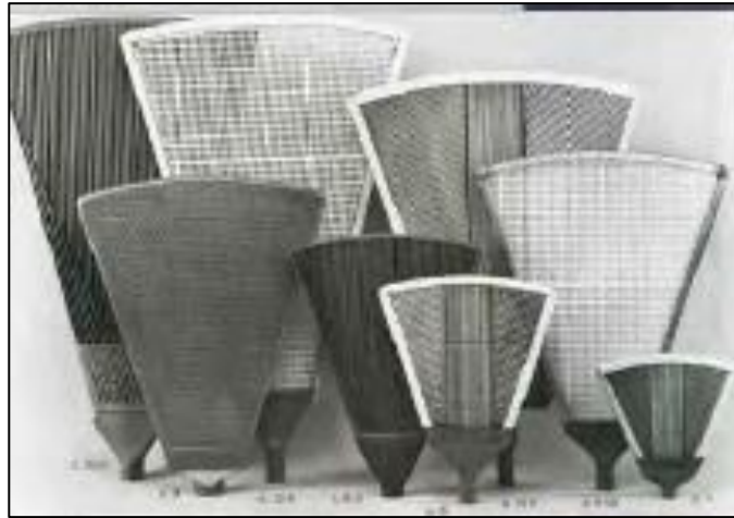
Figura 167 Secciones del filtro de disco.
