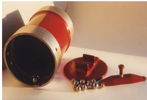
Figura 90 Molino de Bond
