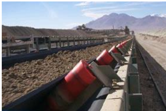
Figura 219 Correa transportadora
