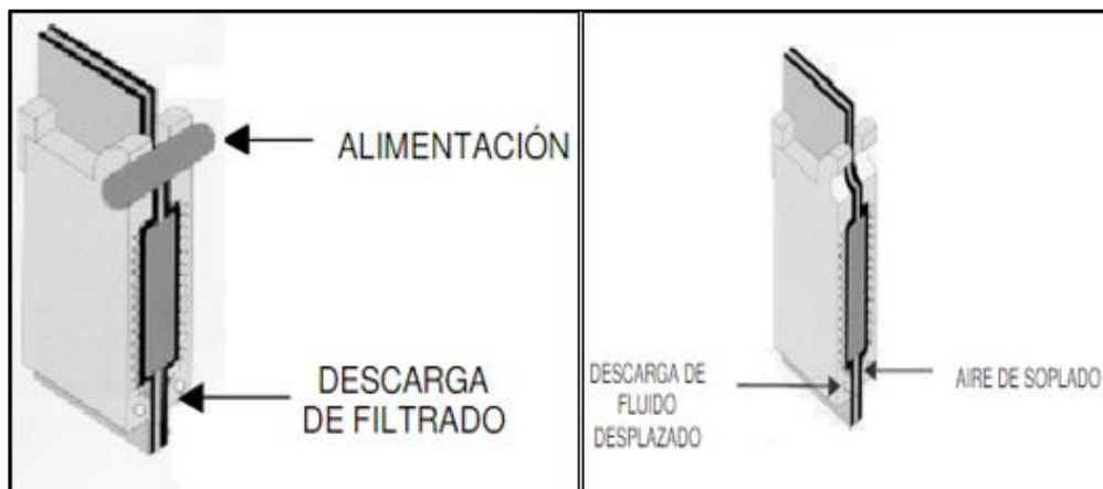
Figura 187 Etapas del filtro vertical
