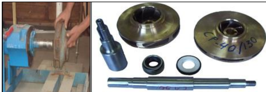
Figura 114 Eje bomba centrífuga
