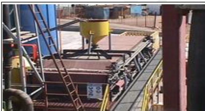
Figura 18 Filtro de banda
