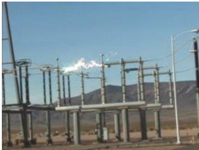
Figura 6 Elongación del arco eléctrico por la acción del empuje térmico.
