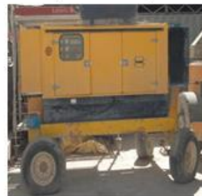
Maquina autónoma que entrega energía a la chutera
