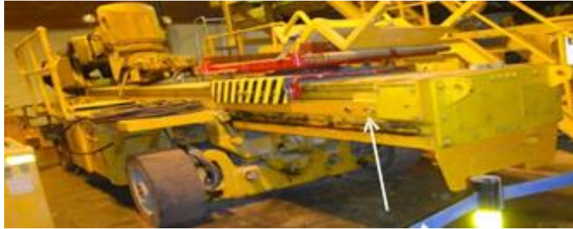
Instalación y retiro de Lainera
