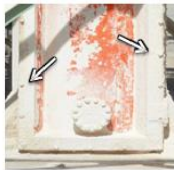
Retiro de pernos de la tapa del molino
