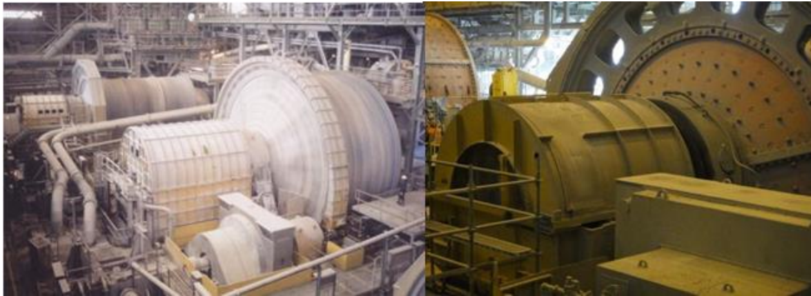
Figura 2 Molino de bolas
