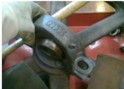
Cambio de rodamientos de un ventilador con altas vibraciones y sonidos extraños
