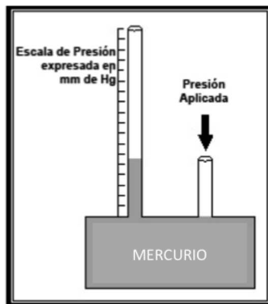
Manómetro lleno de mercurio
