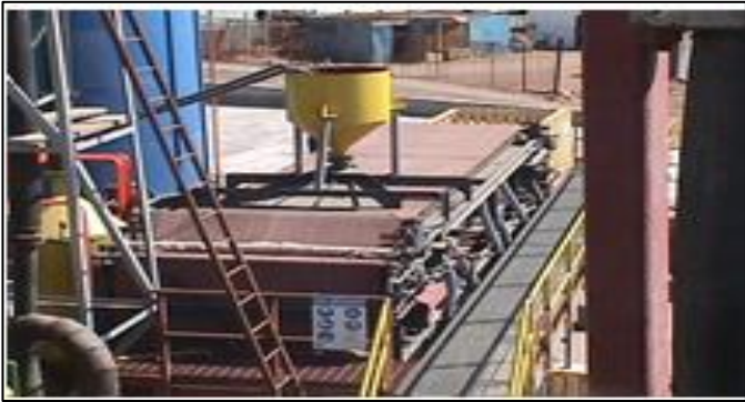
Figura 25 Filtro de banda
