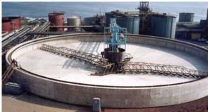
Figura 24 Espesador
