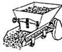
Alimentador con placa de movimiento alternativo
